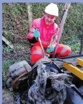
Exemple d'une pompe obstruée par les lingettes sur le territoire de l'Eure
