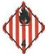
N°4.1 Danger de feu (matière solide inflammable)
